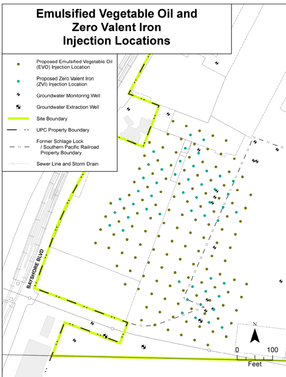
Puntos de Inyección para la Limpieza del Agua Subterránea Schlage OU/UPC OU
